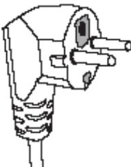
Este aparato debe estar conectado a tierra. Si ocurriese un cortocircuito, la toma de tierra reduciría el riesgo de descarga eléctrica al proveer un cable de escape para la corriente. Este aparato está equipado con un cable para tener un hilo y un enchufe de tierra. El enchufe debe estar conectado a una salida apropiadamente instalada.
